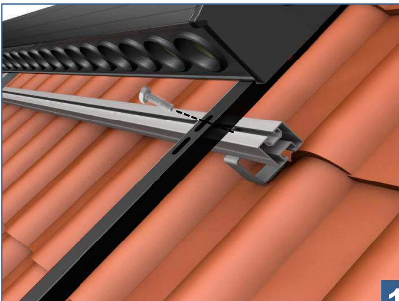
**11** Legen Sie den Kollektorrahmen an die Nutensteine / Verbindungspunkte und befestigen Sie diesen an den vorhandenen Langlöchern mit M8 Schrauben Nutenstein (Teil des Verschraubungskit [4]).
