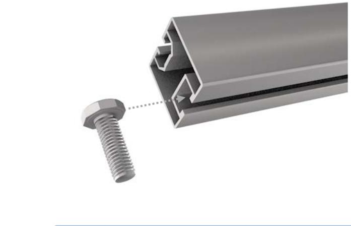
**8** Schieben Sie den Kopf der M10 Schrauben (Teil des Verschraubungskit [4]) in die Nut auf der Unterseite des Montageprofils [3]. Für jeden Dachhaken eine Schraube.
